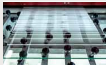
Weiterverarbeitung zu Sicherheits-Glas im ESG-Ofen
