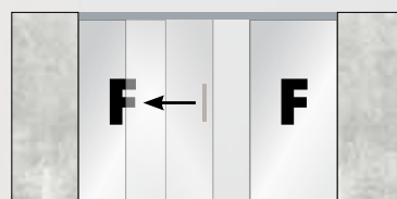
1 Tür mittig, nach links oder rechts öffnend, 2 Elemente links und rechts, Breite bis 3390 mm
