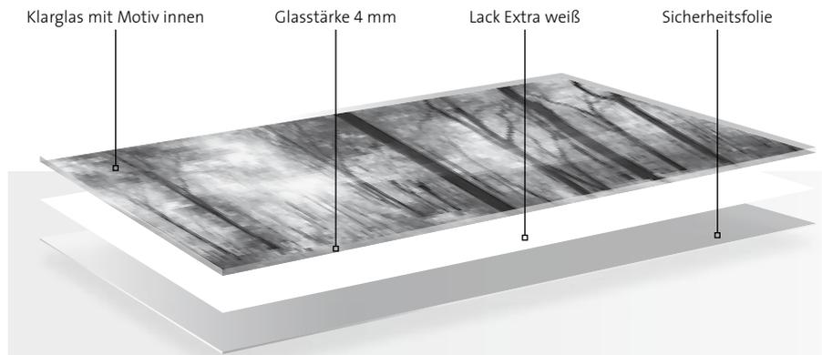
Das Bildmotiv wird in vielen kleinen Farbpunkten rückseitig auf die Klarglasscheibe übertragen und danach im Farbton Extra weiß vollflächig lackiert. Der 500 mm hohe Glasstreifen wird abschließend mit einer Sicherheitsfolie versehen und in den Aluminium-Rahmen der Gleittür eingebaut. Der Digitaldruck ist bis zu einer Gleittürbreite von 1200 mm möglich.
