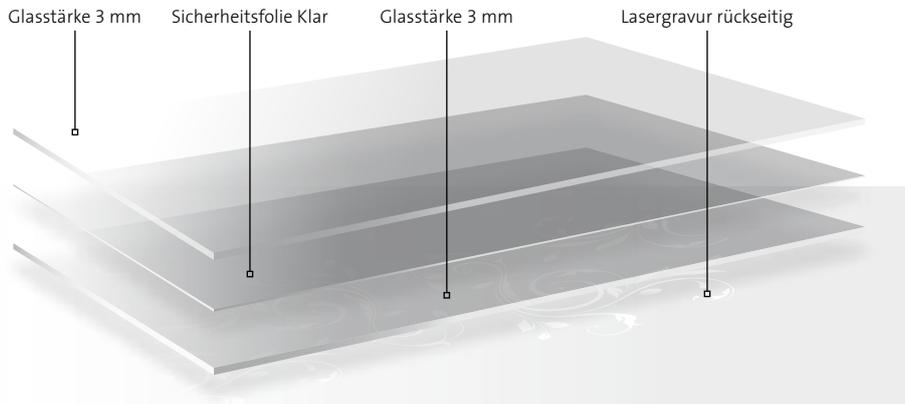
Für die Lasermattierung im Farbton Satiniert wird 6 mm dickes Verbund-Sicherheits-Glas verwendet. Nach der Glasgravur wird der 500 mm hohe Glasstreifen in den Aluminium-Rahmen der Gleittür eingebaut.
