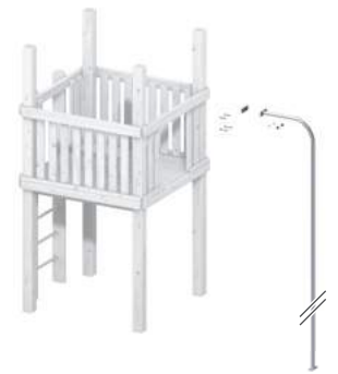
Art. 3107 Feuerwehrstange 219.00 Edelstahl, Gesamtlänge: 310 cm, Höhe über dem Boden: circa 230 cm Rohrdurchmesser: Ø 3,4 cm, mit Bodenplatte zur Befestigung im Betonfundament
