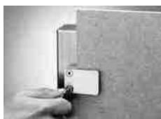
Einfach Holzplatten an Pfosten montieren.
