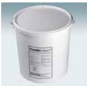
Wasserglas-Kaolin-Kleber, rein anorganisch, nicht brennbar A1. Verarbeitbar bis ca. -7 °C. Zur Verklebung der Stossstellen von Conlit® Platten und Conlit® Schalen.
