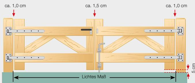
Doppeltore haben in der Regel einen Standflügel (mit Feststeller fixiert) und einen Gehflügel. Bitte geben Sie auch hier DIN-Richtung des Gehflügels an (siehe Text Abb. 5)
