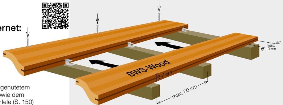
Praktische und einfache Verlegung mit vorgegenutetem Qualitäts-Holz (**BWS Wood**, S. 118-121) sowie dem **BWS-Befestigungssystem** von Braun&Würfele (S. 150) bzw. dem **TuttoDuo** (Aufbauanleitung, S. 151)
