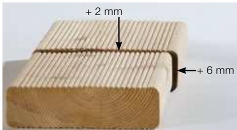
1. Beispielhaft: Gleiches Holz trocken (18%) und nass (hinten).
