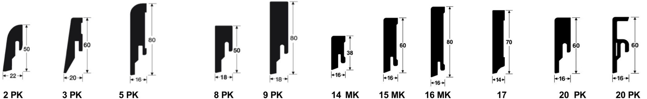
**Sockel passend zu DD/DL 600, DD/DL 500, DD/DL 400, DD 200**
